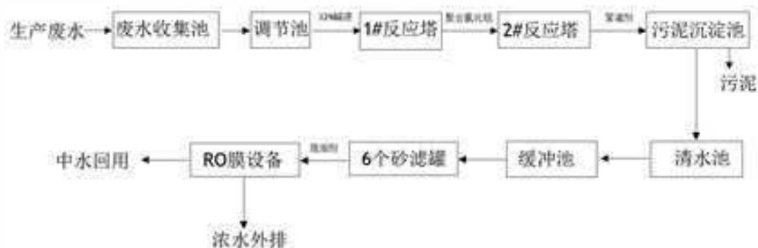
图 3.8-1 污水处理站处理工艺流程图
